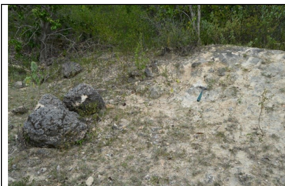
Figura 4.7. Afloramiento de la capa Ingeniero geológica Tipo IG-II en la cima de la loma de rocas margosas con fragmentos de calizas y calcarenitas de la Fm. Júcaro.
