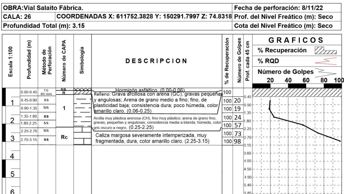
Figura 39. Columnas litológicas por calas perforadas 26 y 26.
