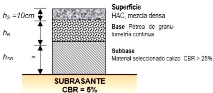
Figura 26. Esquema de la estructura del vial según requisitos de la norma NC 334-2004.
