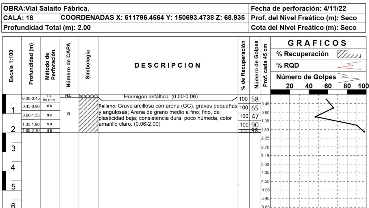
Figura 35. Columnas litológicas por calas perforadas 17 y 18.
