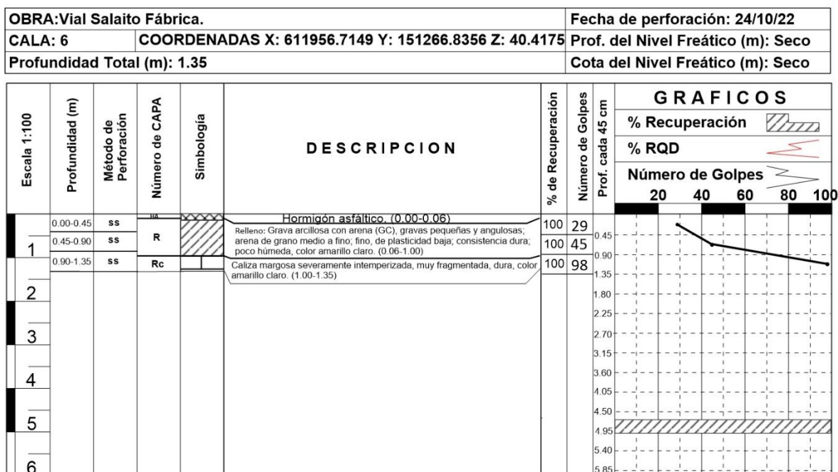
Figura 33. Columnas litológicas por calas perforadas 5 y 6.
