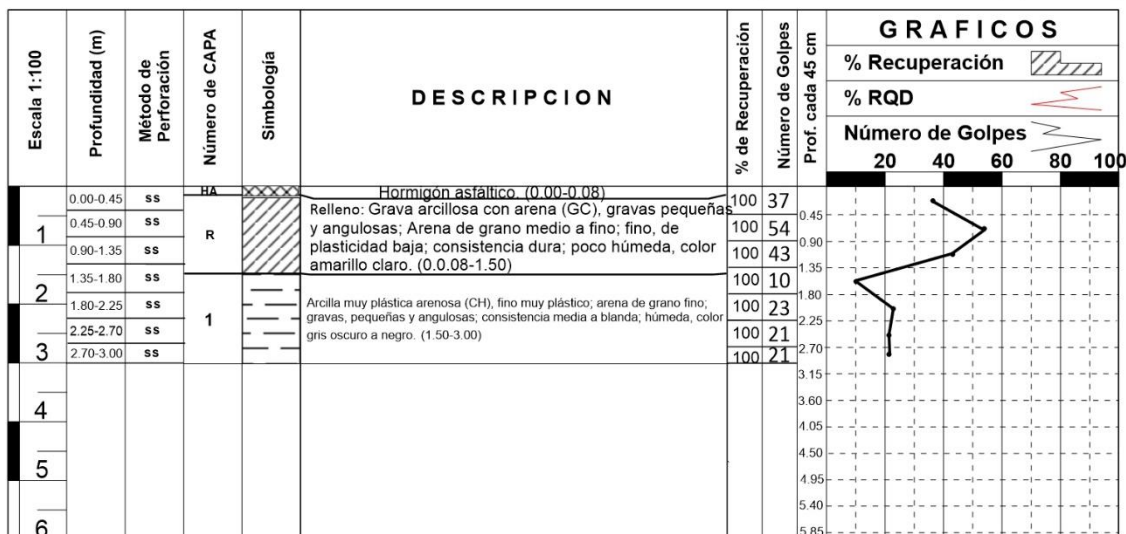
Figura 32. Columnas litológicas por calas perforadas 3 y 4.
