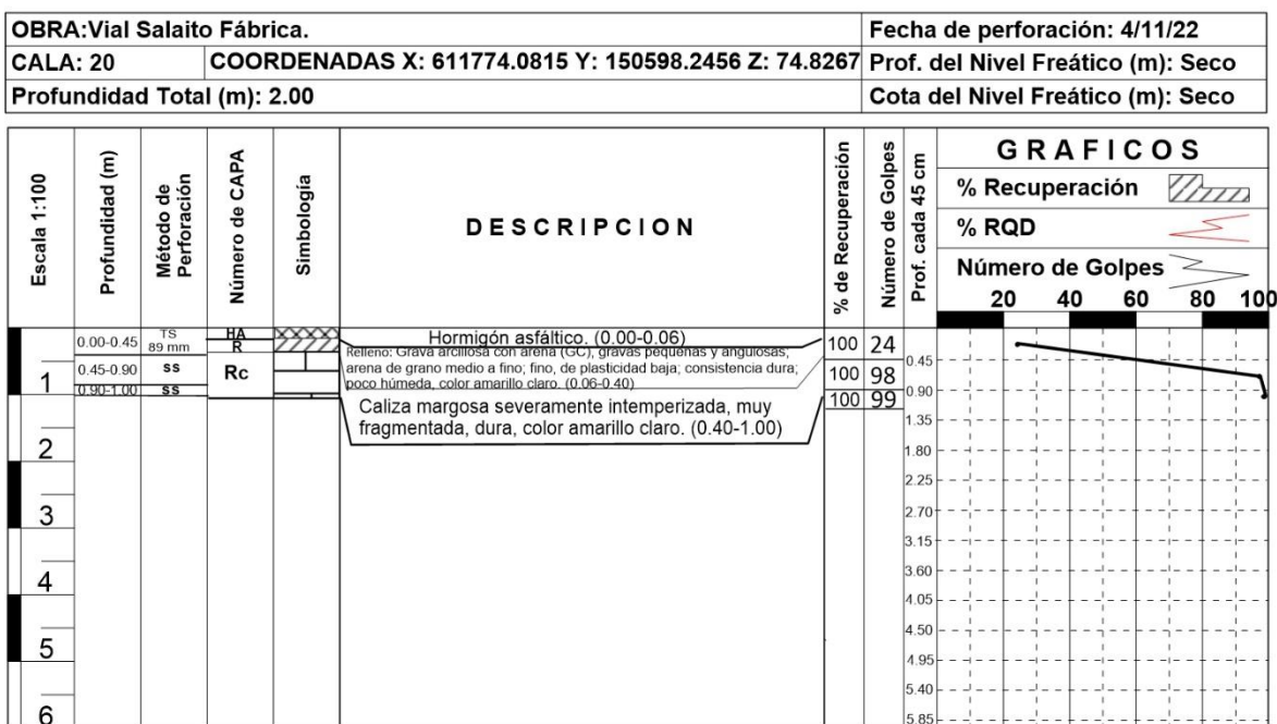
Figura 36. Columnas litológicas por calas perforadas 19 y 20.
