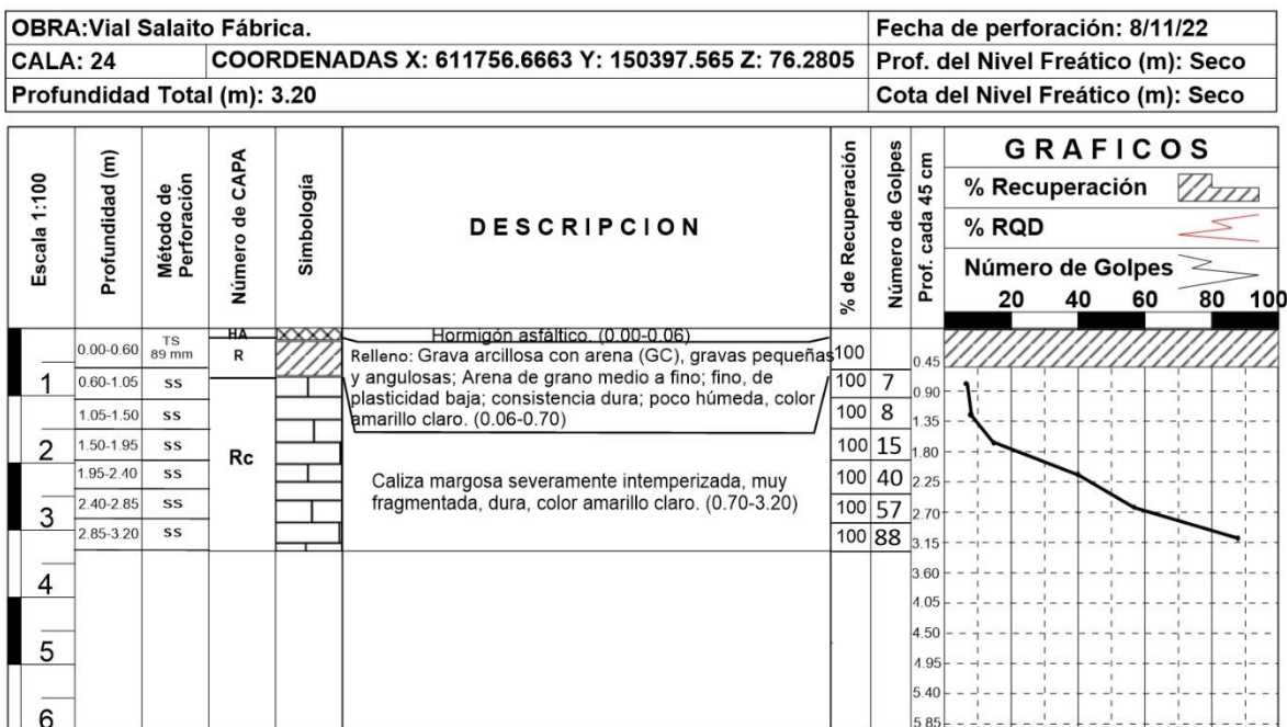
Figura 38. Columnas litológicas por calas perforadas 23 y 24.
