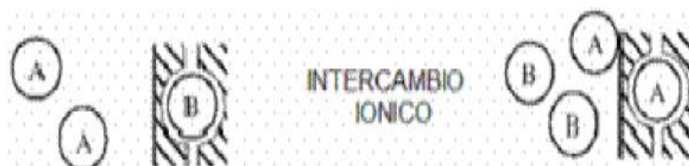
Figura 1.4: Representación esquemática del proceso de intercambio iónico
