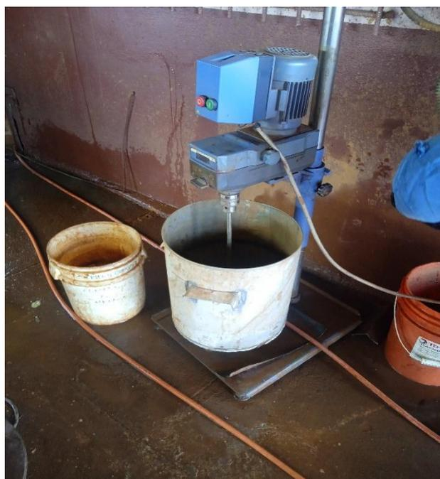
Anexo 5. Agitadores de hélices con impelente mecánico IKA RW 47 D
