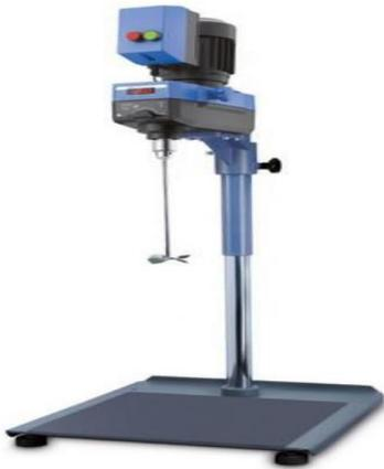
D, como se muestra en la Figura 2.2, hasta formar una pulpa. Se recomienda un régimen de agitación intenso, moviéndose en el rango de 700 a 800 rpm, la cual se debe ir regulando a medida que se observe el espesamiento del mineral. Se recomienda no agitar por un tiempo superior a los 5 min debido a que podría ocasionar cambios en las propiedades reológicas del mineral lo que incidiría directamente en los resultados al alcanzarse valores en la velocidad de sedimentación alejados del valor real.
