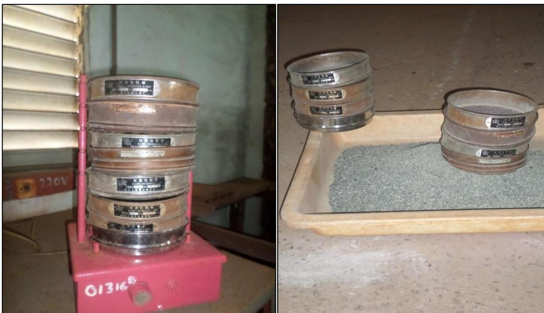
**Figura 11.** Juego de tamices empleados durante la caracterización física de las muestras seleccionadas.
