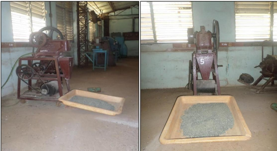
**Figura 10.** Proceso de preparación mecánica de las muestras seleccionadas.
