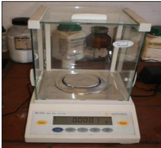
**Figura 13.** Balanza utilizada para el pesaje de las muestras.
