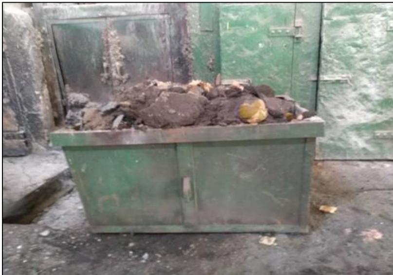
**Figura 17.** Arena residual del proceso de moldeo recolectada para enviar a los vertederos de Moa.
