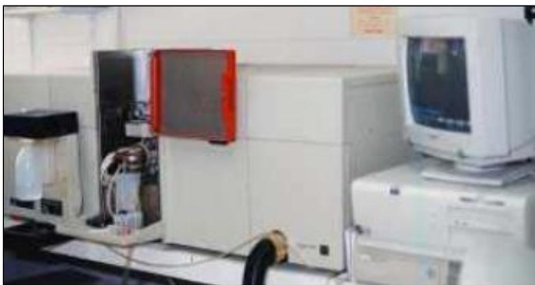
**Figura 12.** Equipo de Espectroscopia de Absorción Atómica empleado en los análisis químicos.
