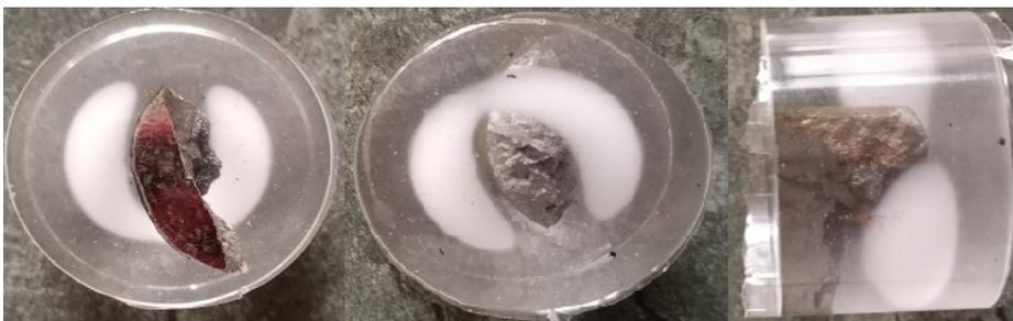
Figura 2.4. Encapsulado de las muestras con resina epoxi ROYAPOX - 5050.
