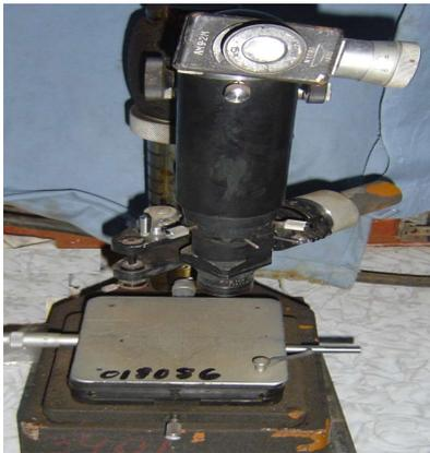
Figura 2.7. Microscopio para la medición de microdureza.
