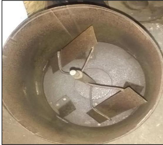
**Figura 8.** Mezcladora empleada para la conformación de las mezclas experimentales.
