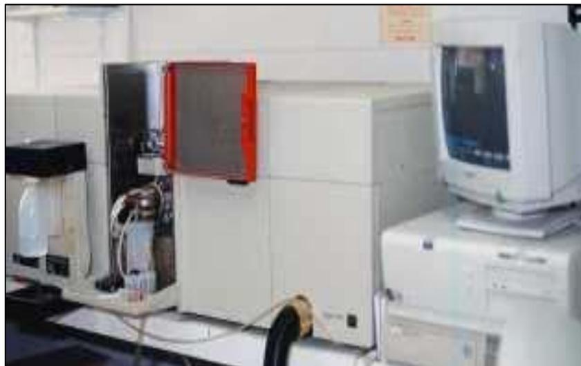
**Figura 15.** Equipo de Espectroscopia de Absorción Atómica empleado en los análisis químicos.
