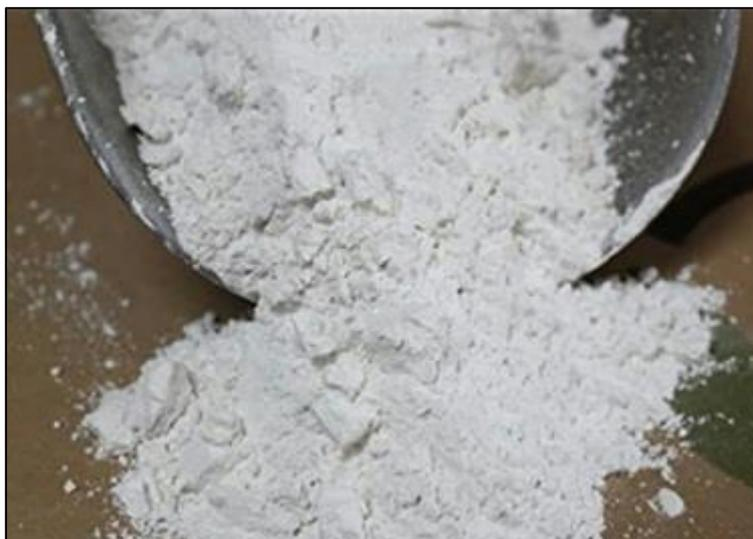
**Figura 6.** Caliza utilizada como fundente en las pruebas experimentales.
