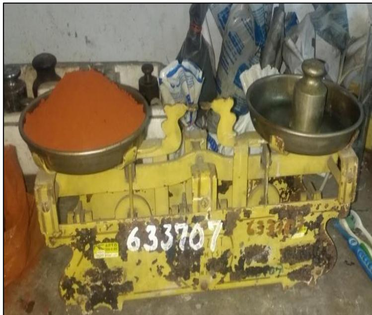
**Figura 9.** Balanza técnica empleada para el pesaje de los materiales y productos obtenidos en las pruebas experimentales.
