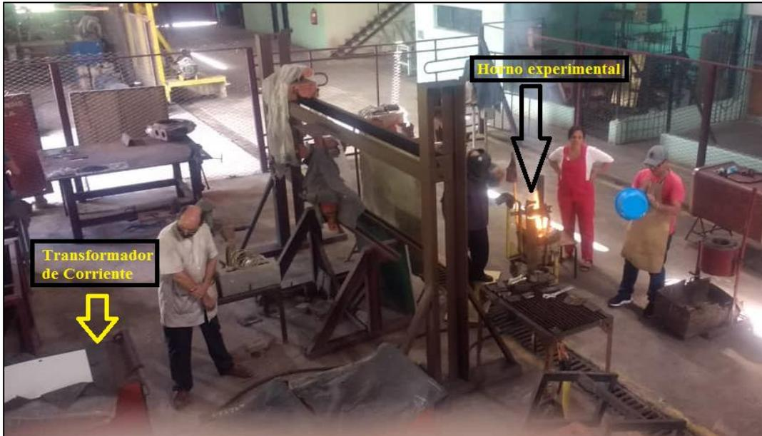
**Figura 11.** Sistema horno eléctrico-fuente de corriente directa.
