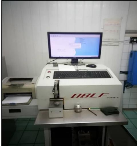
**Figura 14.** Espectrómetro de masa utilizado para la caracterización química del metal obtenido en las pruebas experimentales.
