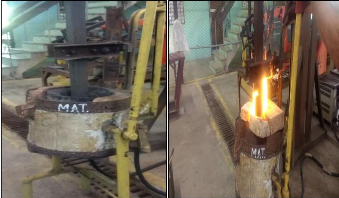
**Figura 10.** Crisol de grafito empleado en las pruebas de fusión reductora.
