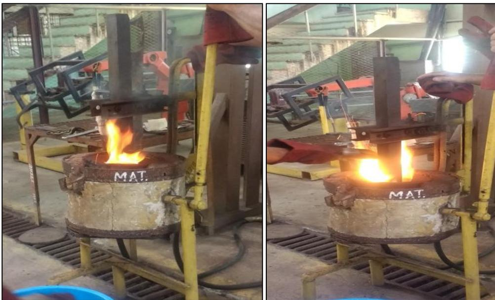
**Figura 12.** Obtención del metal a través de la fusión reductora.
