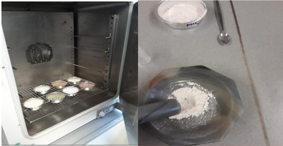
Figura 19. Mufla con ventilación interna y mortero de ágata
