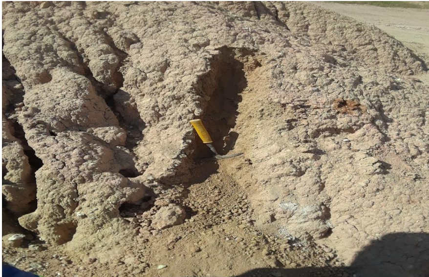
Figura 11. Detalle del surco de muestreo en escombrera
