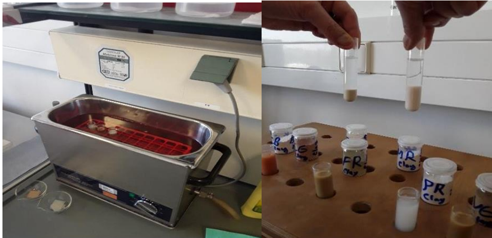
Figura 20. Máquina de ultrasonido y muestras en disolución con rápido asentamiento de la fracción no arcillosa
