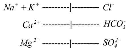
Figura 3.1. Esquema del diagrama propuesto por Stiff.
