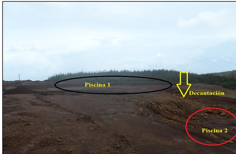
Figura 5: Proceso natural de decantación de finos entre las piscinas de sedimentación.
