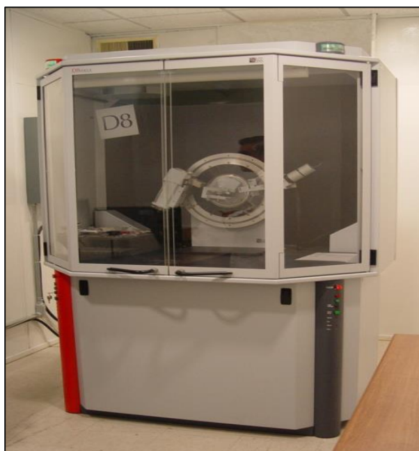
Figura 3: Equipo de Difracción de Rayos X, empleado para los análisis mineralógicos.
