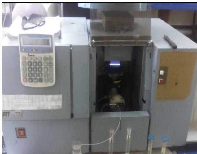
Figura 2: Equipo de Espectrofotometría de Absorción Atómica empleado en los análisis químicos.
