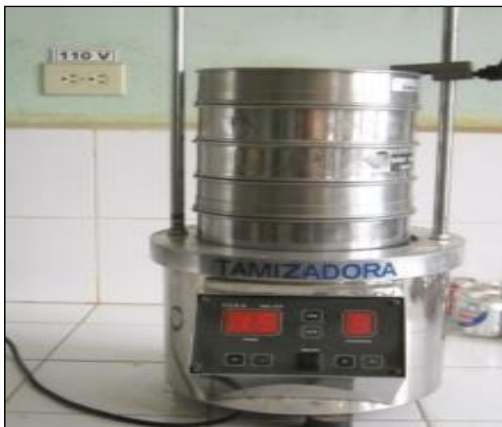
Figura 4: Tamizadora eléctrica empleada en los análisis granulométricos.
