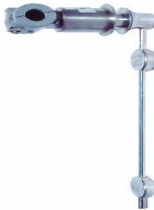
Figura 3.4: El transmisor inteligente de densidad y concentración Smar DT301 utiliza el principio de medición de presión diferencial entre dos puntos separados por una distancia conocida y fija, y puede utilizarse tanto en tanques como en línea.
