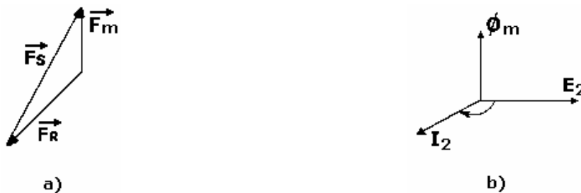
Figura 3.3: a) Diagrama vectorial de la máquina de inducción trabajando como generador en la zona estable.
