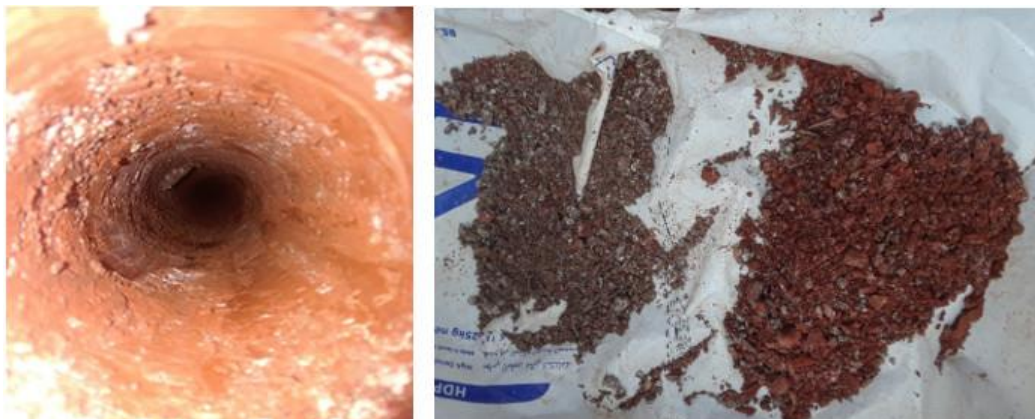
Figura 15: a) perforación, b) material recuperado de la perforación manual.
