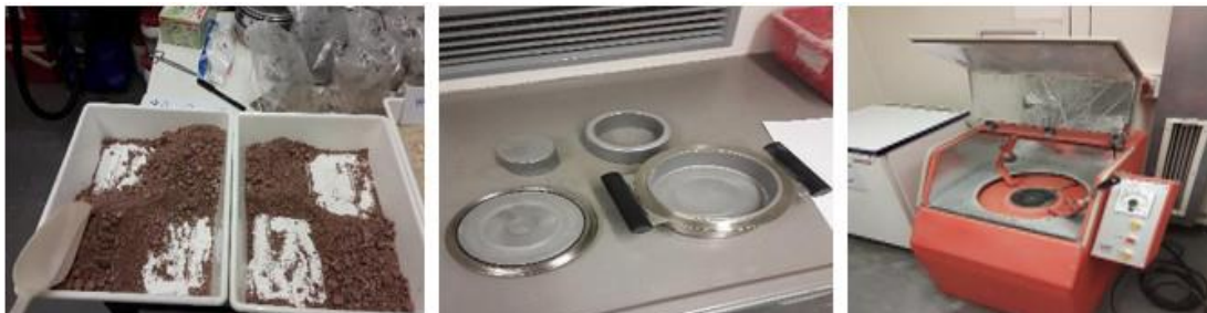
Figura 21: a) cuarteo en bandejas, b) accesorios del molino de anillos, c) molino de anillos
