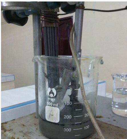
Figura 2.2. Modo de ataque de las muestras por electrólisis.
