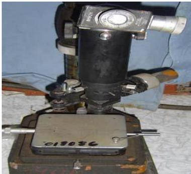
Figura 2.5. Microscopio utilizado para el ensayo de microdureza.
