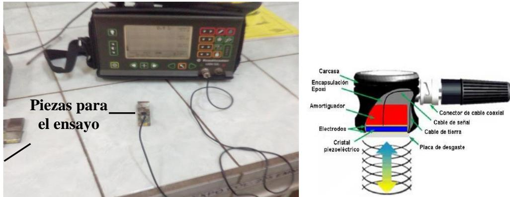
Figura 2.9. Equipo de ultrasonido y esquema del palpador ultrasónico empleados.
