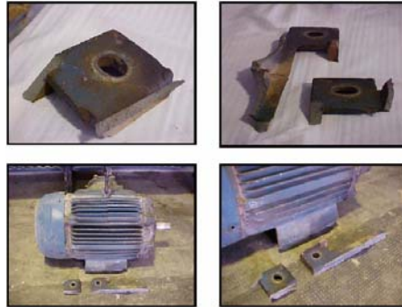
Figura 1.3 Daños por altas vibraciones.
