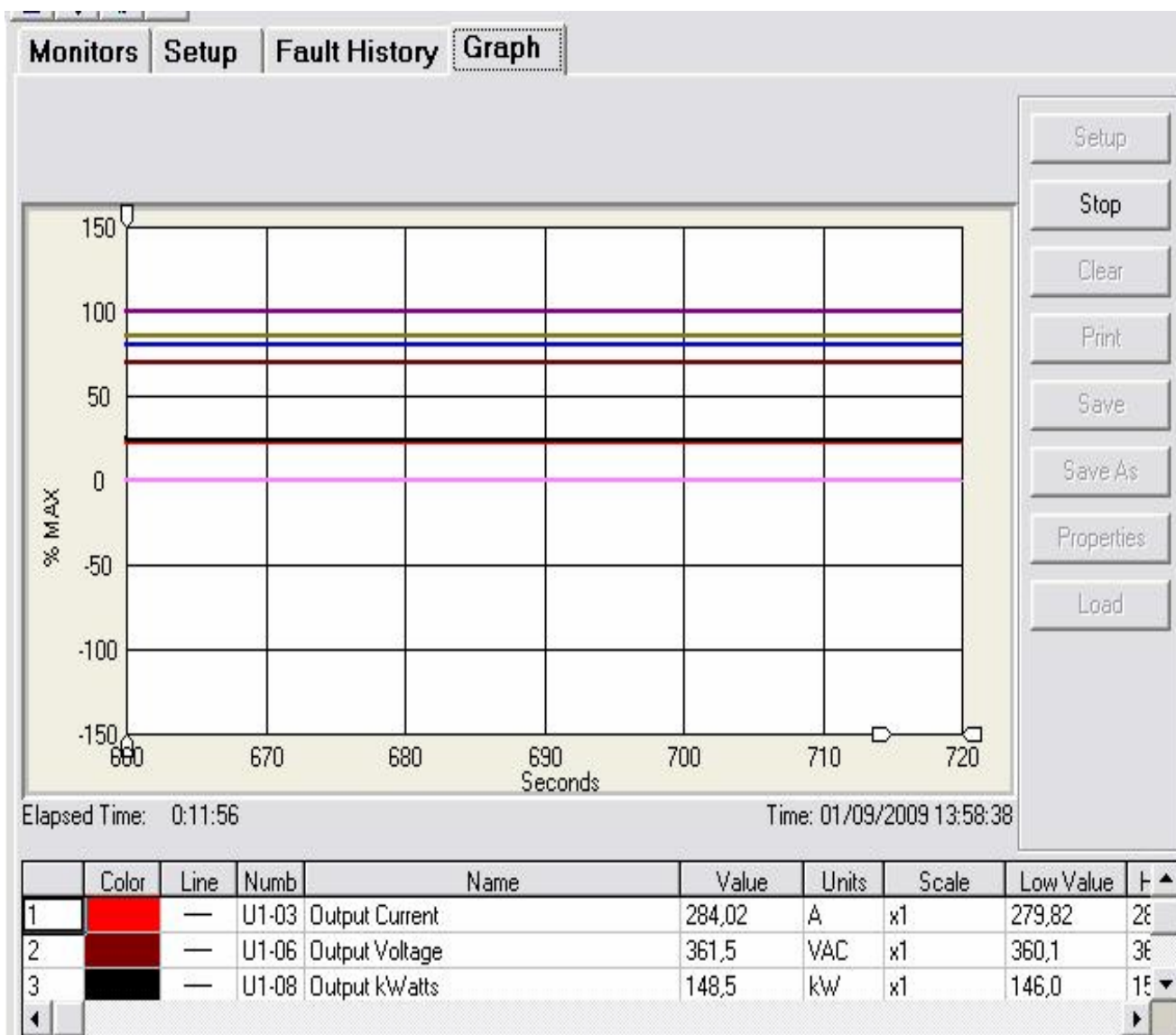
Figura 3.2c Foto del programa Drive Wizard con los gráficos del (VFD).
