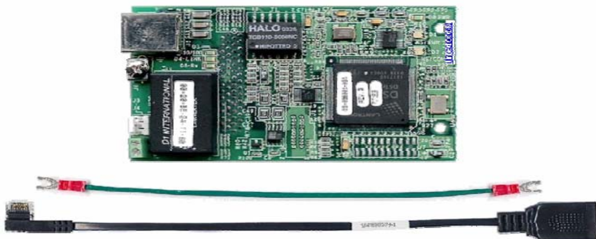
Figura 3.2b Tarjeta opcional PCB, Ethernet (3G3RV-PDRT2).
