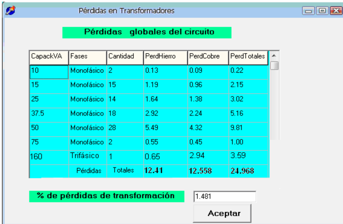
Figura 2.12: Pérdidas en los transformadores del Circuito N° 6.
