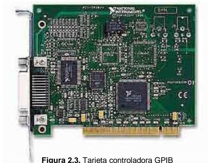
Figura 2.3. Tarjeta controladora GPIB
