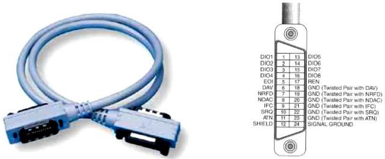
Figura 2.2. Cable de conexión GPIB: aspecto físico y distribución de señales.
