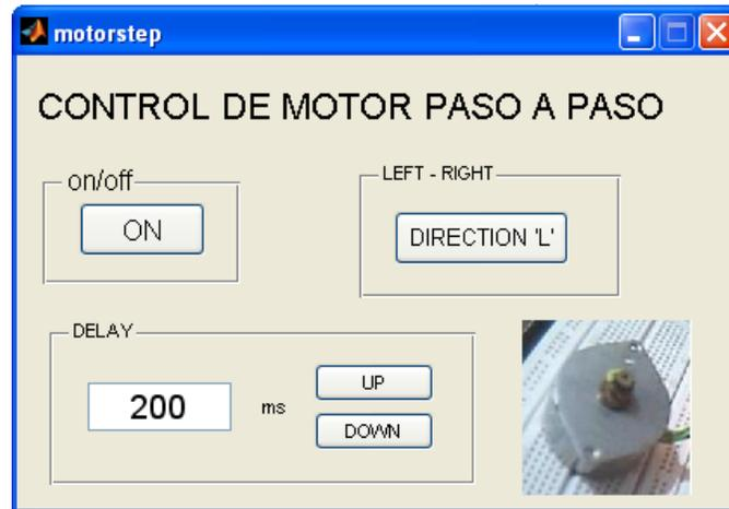
Figura 4.1. Interface para el control del motor paso a paso
