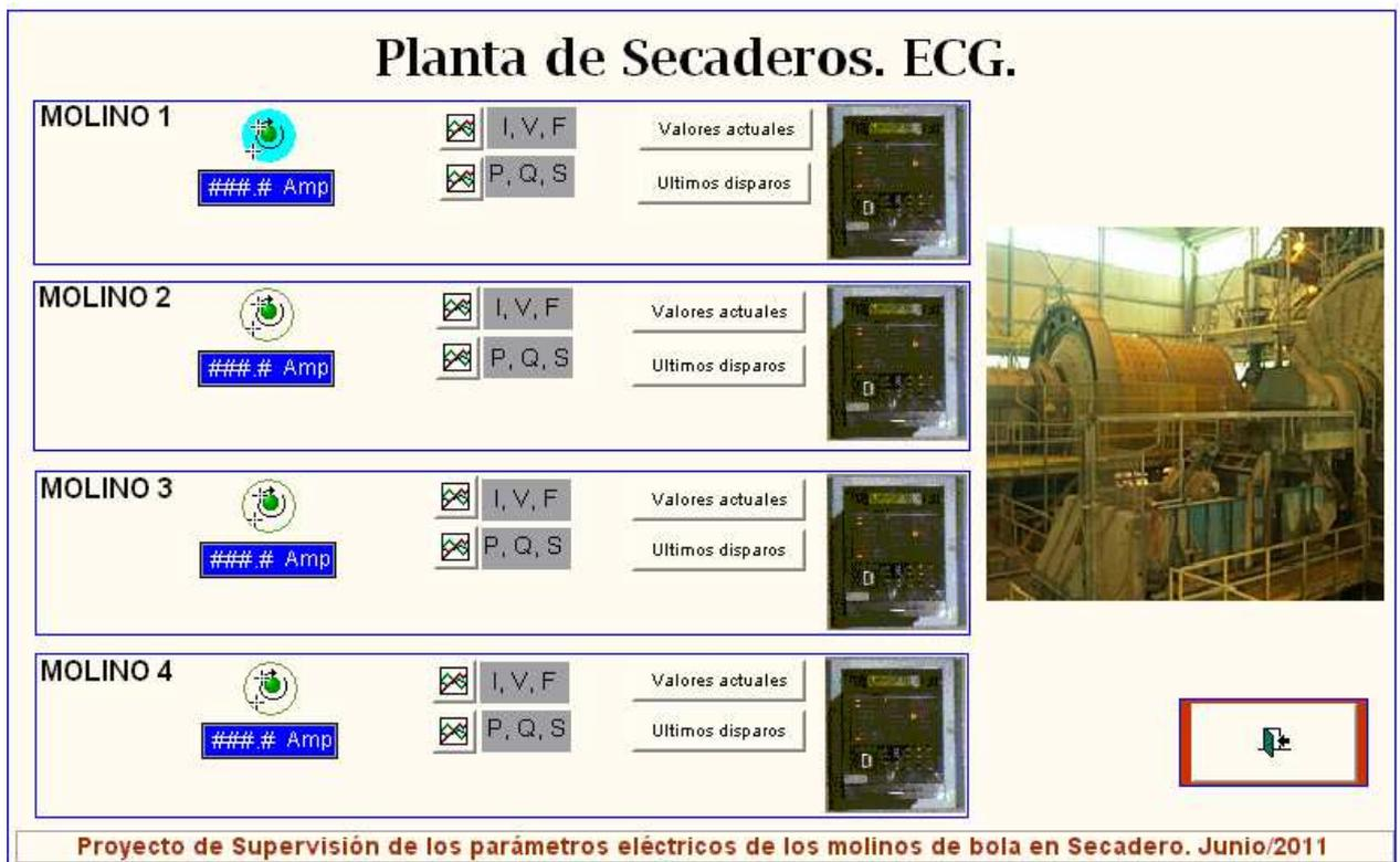
Figura 3.2 Representación del HMI general de control supervisor .
