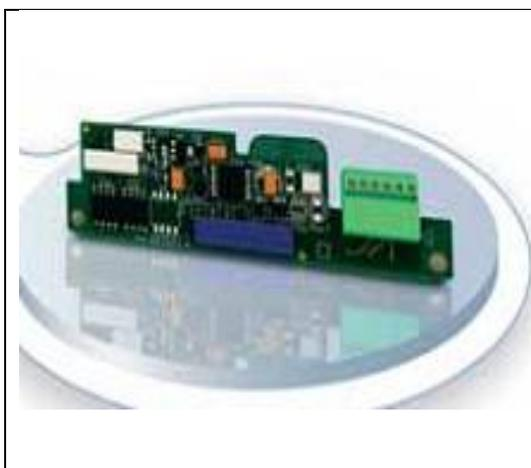
Tarjetas de interface para codificador de tipo incremental o absoluto: RS422, de colector abierto, Push Pull RS422 con emulación de codificador Resolver
