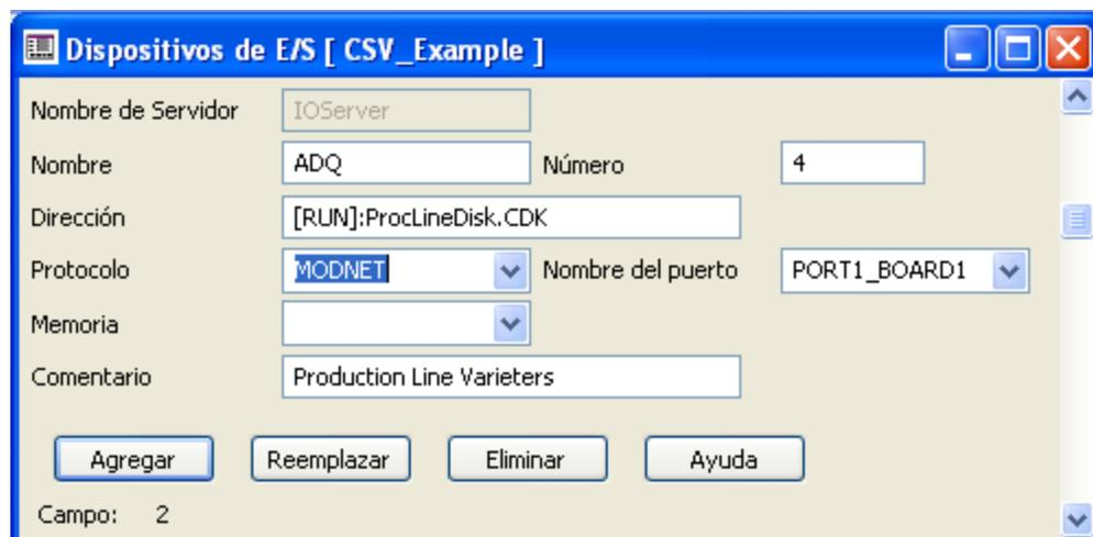
**Fig.3.6** Cuadro de diálogo para la configuración de los protocolos de comunicación del CITECT
