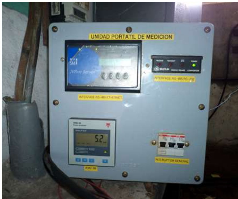
Unidad portátil de medición empleada para las mediciones eléctricas
