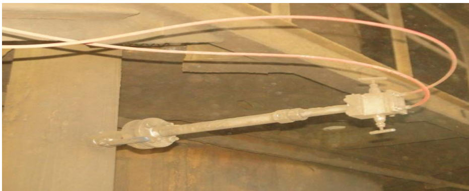
Figura 2.1. Medición de caudal en la línea ø 0,3 m que alimenta las cámaras de combustión
