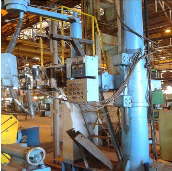
Figura 2.3. Fuente empleada para la soldadura.
