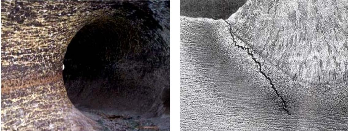
Figura 2.1. Deterioro en el interior de la línea de petróleo. Fuente: Barzaga (2014).
