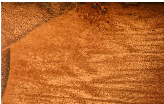
Figura 3.2. Micrografía de la ZAT.
