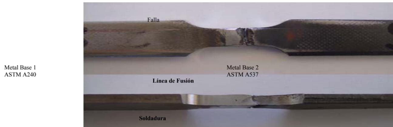
**Fig. 23. Probeta soldada ensayada a fatiga. (García, 2008)**
