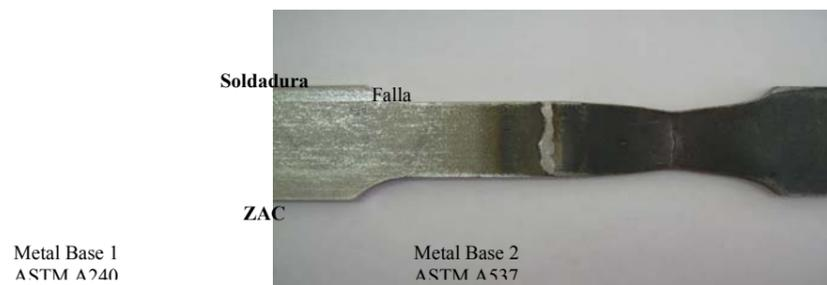
**Fig. 20. Probeta soldada ensayada a tracción.**
