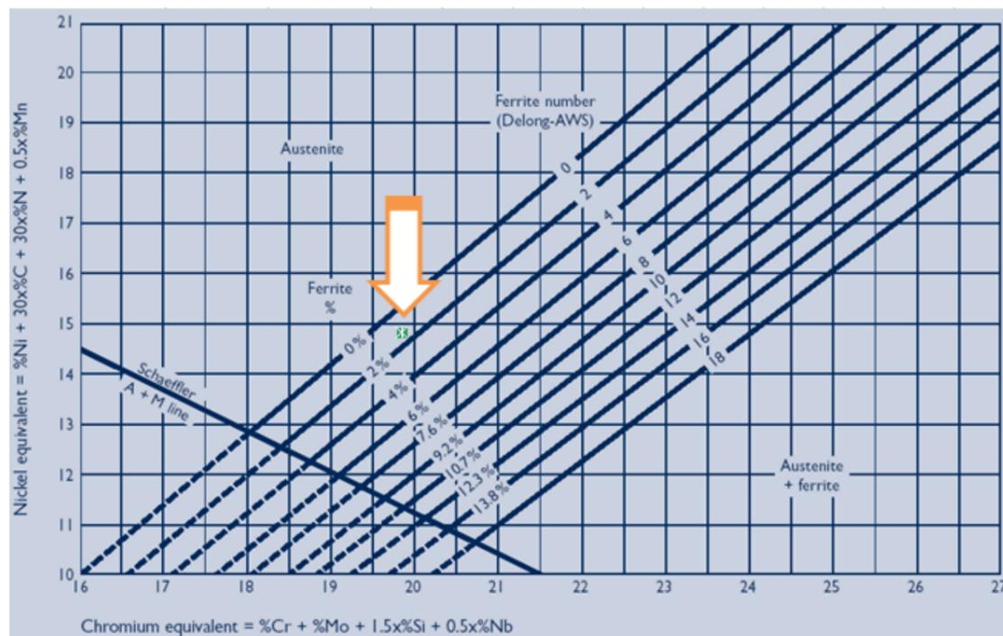
**Fig. 10. Diagrama de DeLong para el MB1-MA, MA-MB2 (AWS, 2007)**
