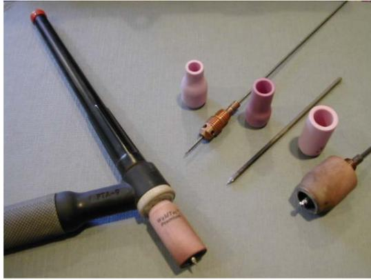
Fig. A4. Accesorios para soldadura TIG, (AWS, 2007)
