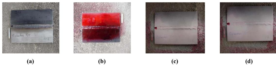
**Fig. 2. Inspección visual mediante líquidos penetrantes (a) junta original, (b) tinte penetrante, (c) y (d) tinte revelador**
