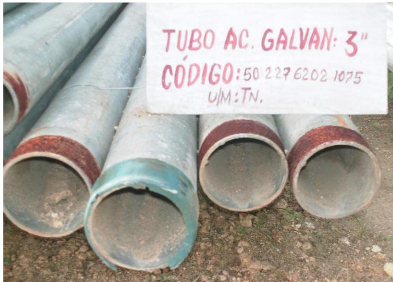
Anexo 11. Micropilote constituido por dos tubos de acero galvanizado
