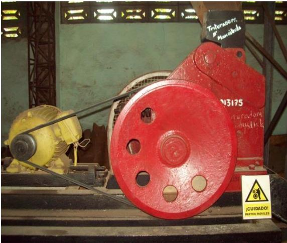
Figura 2.1. Trituradora de mandíbula TQ (320x165).
