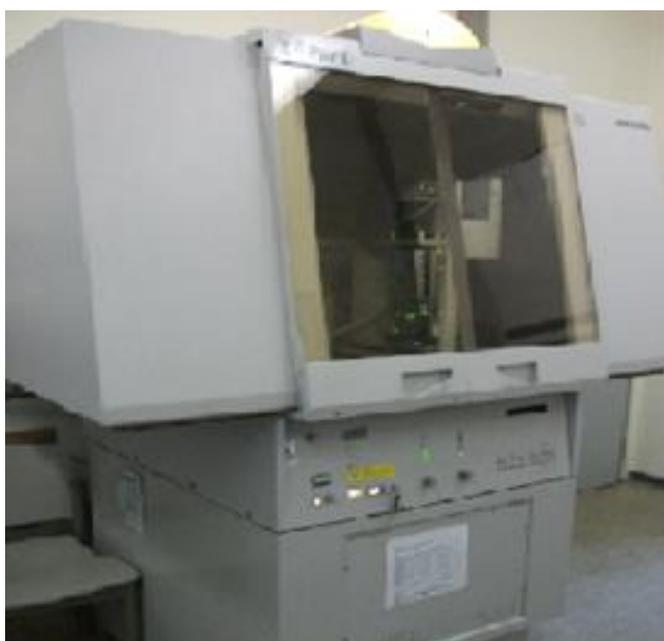
Figura 2.6. Difractómetro Philips X'Pert
