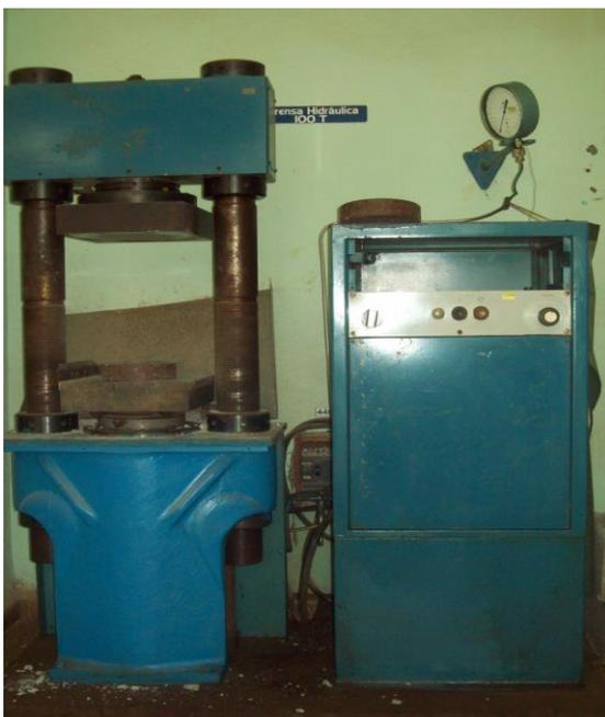
Figura 2.8. Prensa Hidráulica de 100 t
