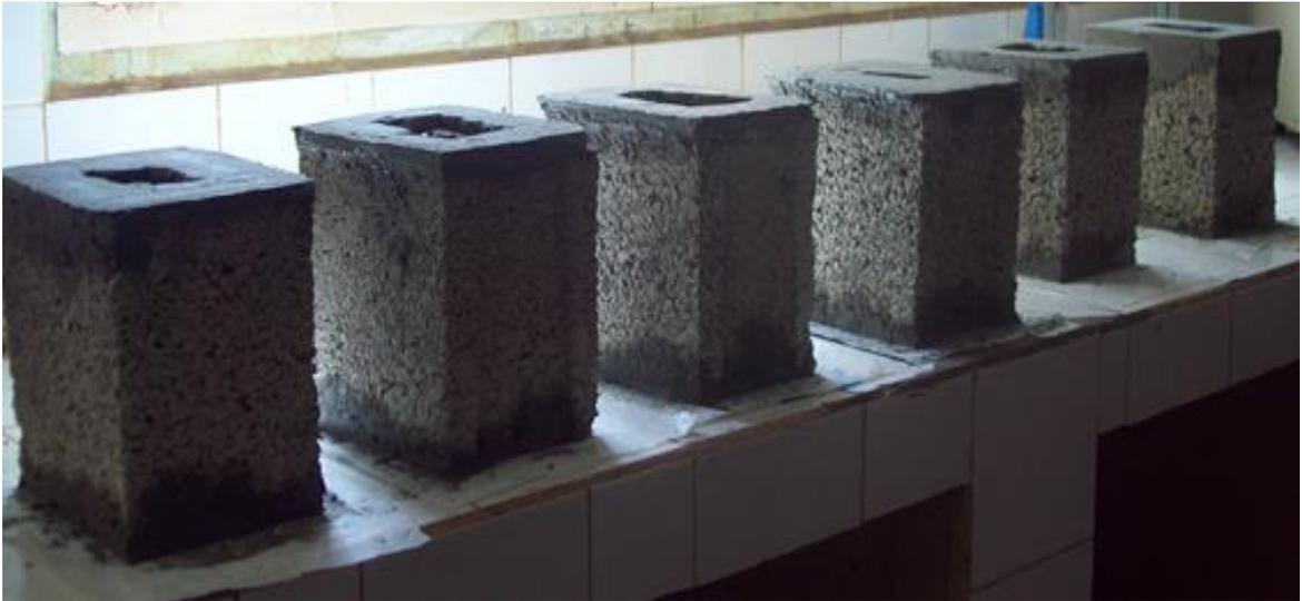
Figura 2.9. Recubrimiento de los bordes del bloque con una capa de cemento P-35
