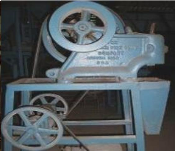
Figura 2.2. Trituradora de mandíbula TQ (150x75).
