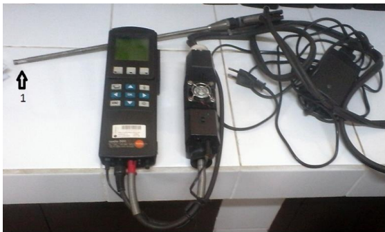
Figura 2.7 Analizador de gases producto de la combustión.1) Sonda de toma de muestra
