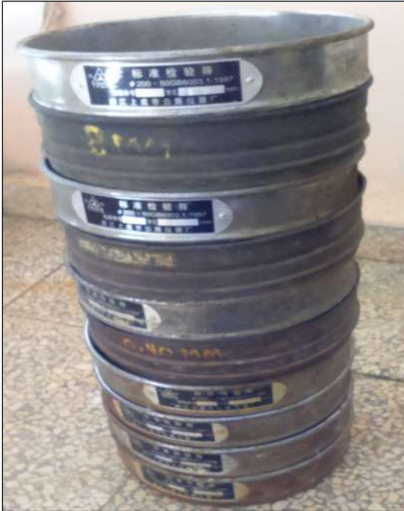
**Figura 10.** Juego de tamices utilizados en el análisis granulométrico.
