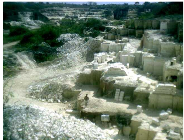
Figura 2.1 Explotación artesanal de Calizas "Blandas" para bloques de construcción en la provincia de Matanzas.
