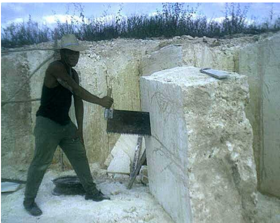
Figura 2.1 Explotación artesanal de Calizas "Blandas" para bloques de construcción en la provincia de Matanzas.
