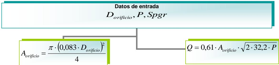
Figura 3.5. Algoritmo para el cálculo de la pérdida por orificio.
