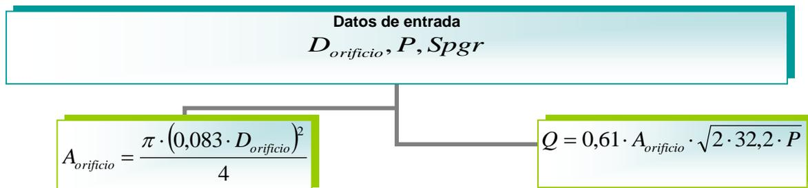
Figura 2.2 Algoritmo para el cálculo de la pérdida por orificio
