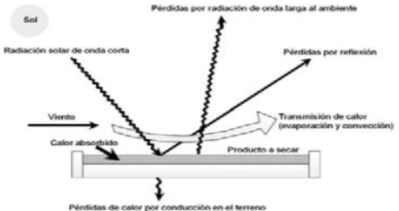
Figura 1. Principio de trabajo del secado directo al sol.
