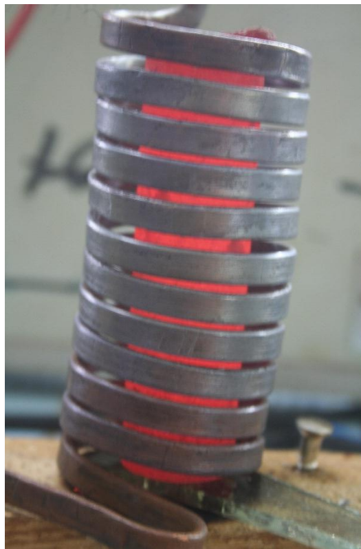
Figura 3.5. Carga conectada a circuito tanque
