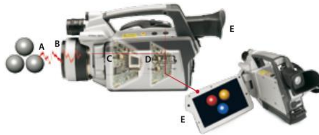
Figura 1.7 Funcionamiento de la cámara termográfica
