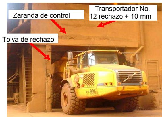
**Figura No. 9. Camión donde se descarga la tolva de rechazo**
