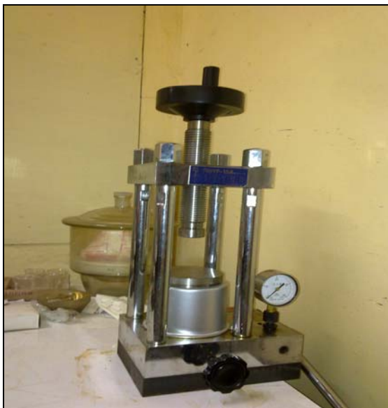
Foto N° .27. Prensa 769P-15A donde se comprime la mezcla
