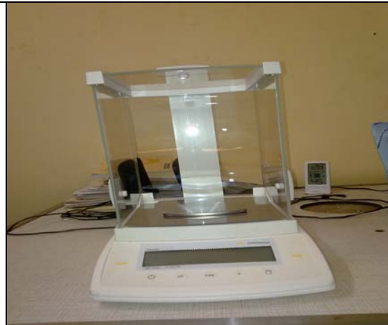
Foto N° .26. Balanza CPA 124S donde se pesan las muestras
