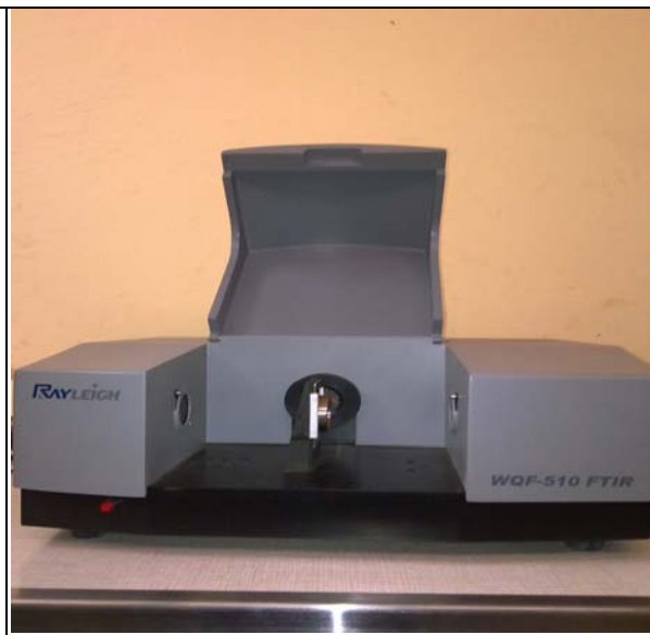
Foto N° .28. Equipo Ray Leigh WQF-510 FTIR emisor de rayos infrarrojo
