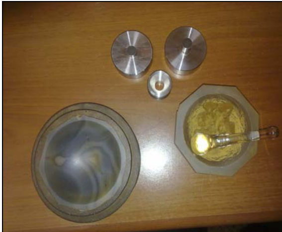
Foto N° .25. Mortero de ágata y molde donde se confeccionan las pastillas
