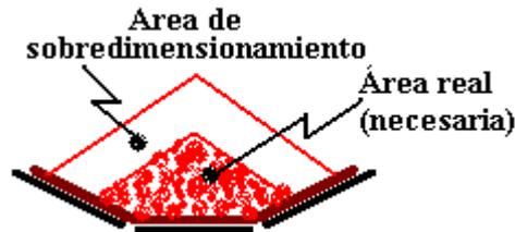
Figura 3.5. Área de sobredimensionamiento del diseño del transportador CO<sub>2</sub>CO<sub>3</sub> de la ECRRL
