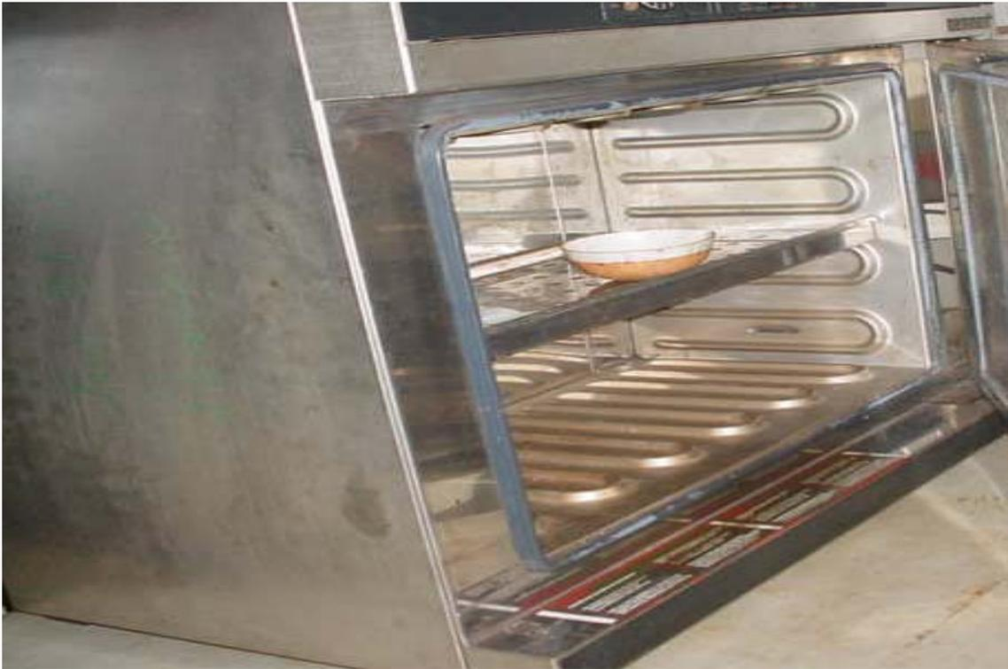
Figura 2.10. Estufa para la extracción de la humedad del mineral laterítico utilizada en el CEINNIQ
