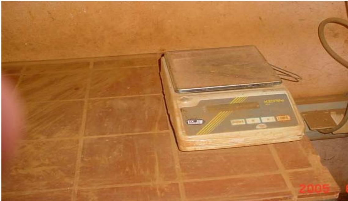
Figura 2.8 Balanza técnica utilizada para el pesaje de las muestras de mineral
