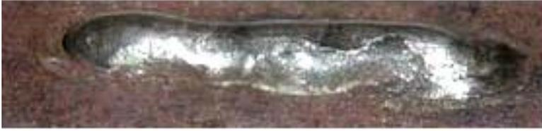
**Figura 6. Depósito de soldadura**
