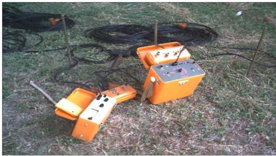
Figura 13: Estación Geo-Eléctrica “TAYATA-2R”, Dispositivo “DSM-24E” y Generador de CC “VIL-3T”.
