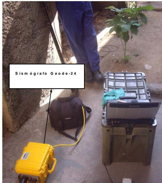
Figura 10: Sismógrafo GEODE-24, marca Geometrics
