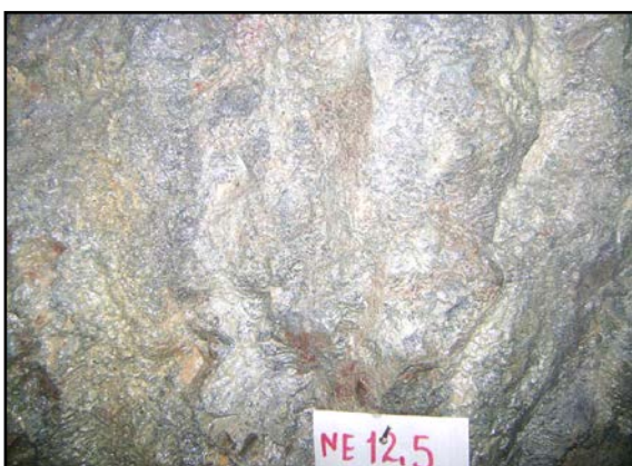
Fig. No. 38. Intervalo desde 12.00 hasta los 12.50 m. Se observan las rocas más compactas, estando en correspondencia con el RQD en esta zona en la Fig. No. 18.
