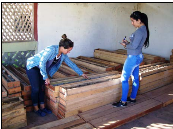
Figs. No. 10 y 11. Imágenes durante la documentación ingeniero geológica del testigo de perforación.
