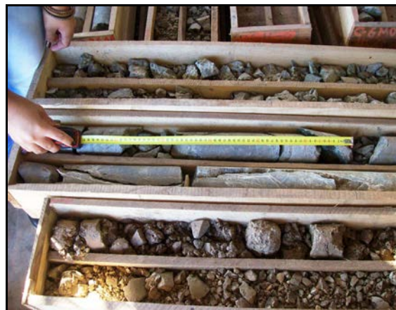
Figs. No. 10 y 11. Imágenes durante la documentación ingeniero geológica del testigo de perforación.
