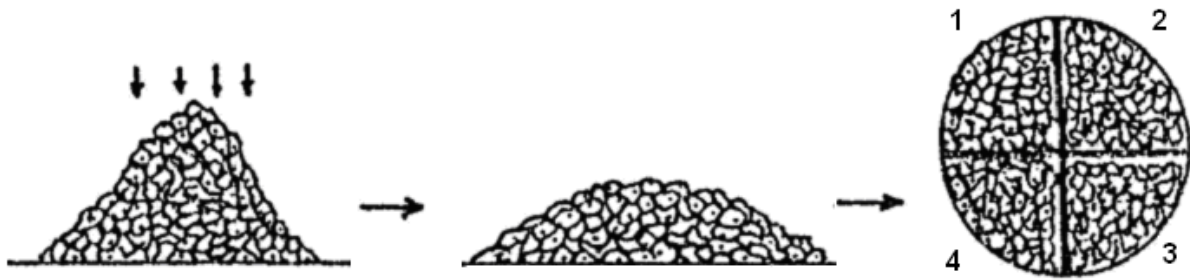
Figura 2.2. Método de cuarteo para la preparación de la muestra.
