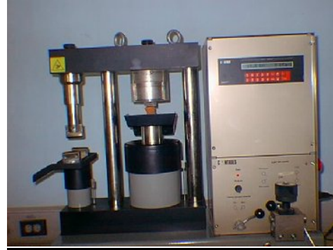
Ensayo de resistencia a la compresión.
