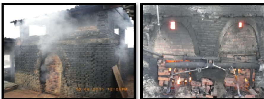
Figura 26. a) Horno artesanal, b) disposición de los quemadores
