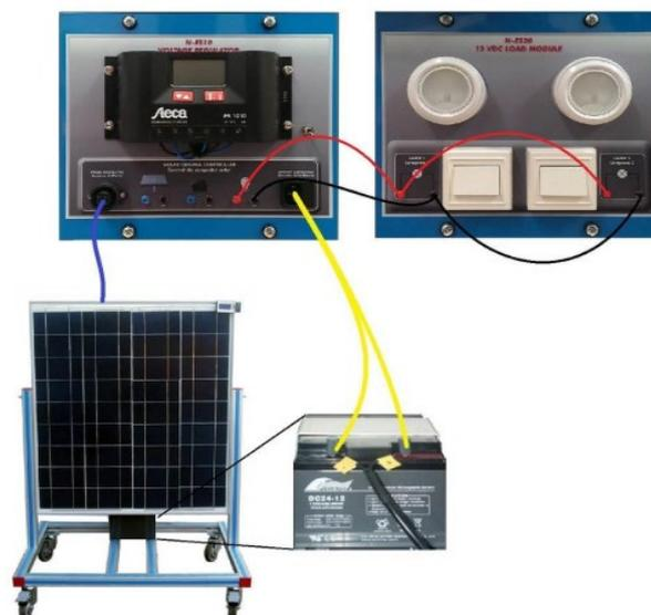
**Figura 2.7 Conexión en paralelo**
