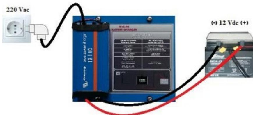
**Figura 2.10: Conexión del cargador de baterías**
