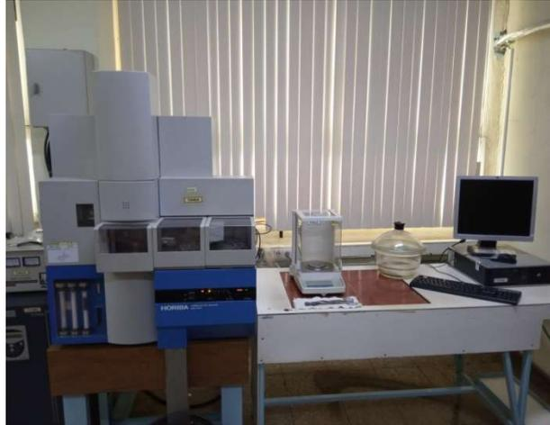
Figura 2.10 Analizador infrarrojo automático, HORIBA
