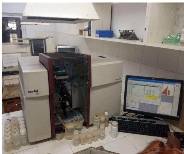
Figura 2.9 Equipo de Espectrofotometría de absorción atómica EAA, Analytik Jena
