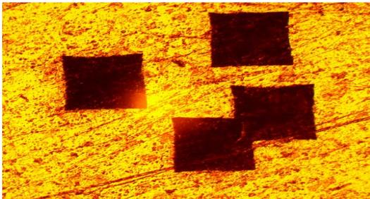
Figura 3.9(a). Barrido de dureza (Cu).
