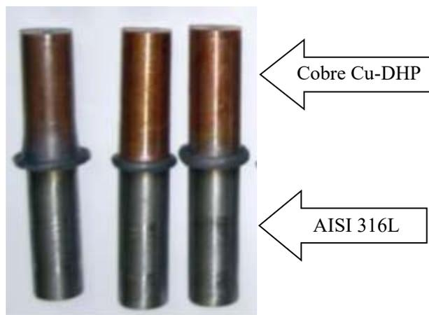
Figura 2.2a. Barras para la junta. Figura 2.2b. Unión realizada por fricción.
