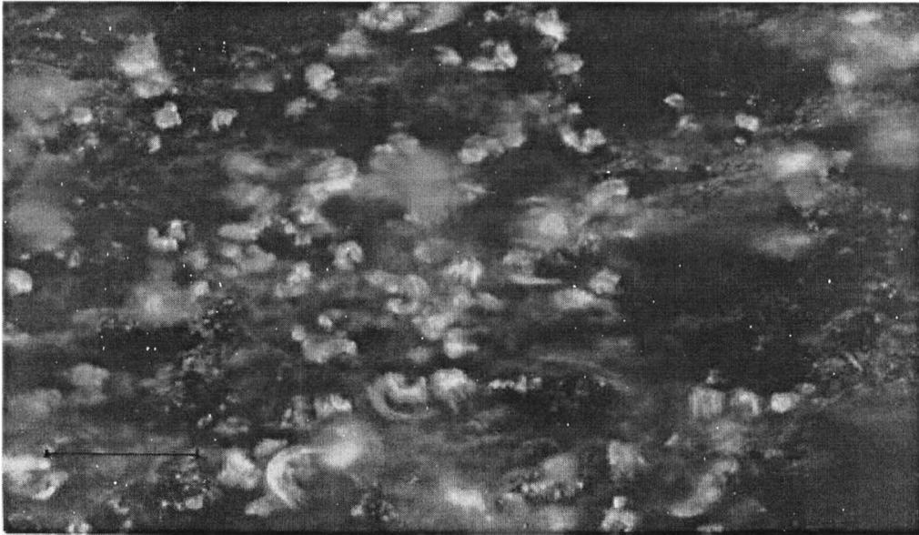
FOTO 9. Mezcla de  $\text{CaSO}_4$  con sulfuros masivos, se aprecia agregados de tonalidad verdosa de  $\text{CuS}$ . La luz reflejada en aire; polarizada elíptica. Aumento 200X JENAPLO-U longitud de la barra 20 ( $\mu\text{m}$ ).
