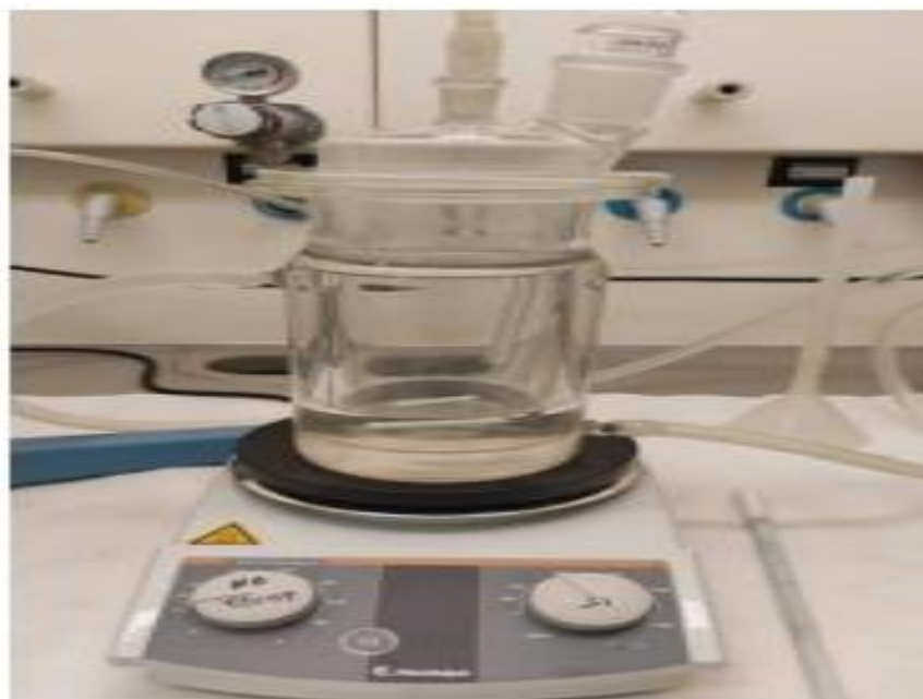
Figura 3: Reactor con spin magnético y disolución en su interior.
