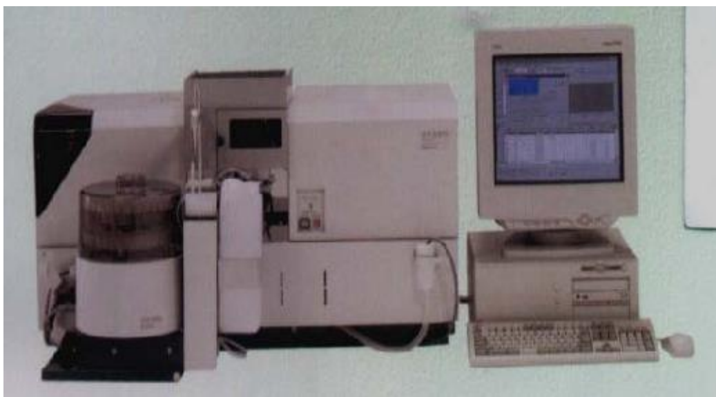
Figura 2.1. Equipo de Absorción Atómica – Avanta GBC.
