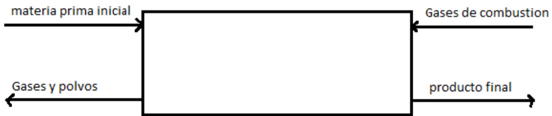
Figura 2.2. Representación esquemática del horno para el proceso de calcinación
